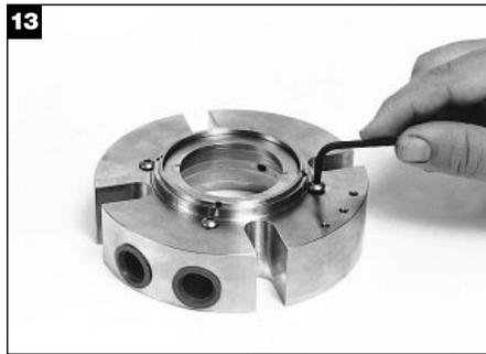
Fixez les vis à tête bombée CMC sur le chapeau, en effectuant un serrage alternatif jusqu'à ce que le dispositif de retenue reste à sa place.
