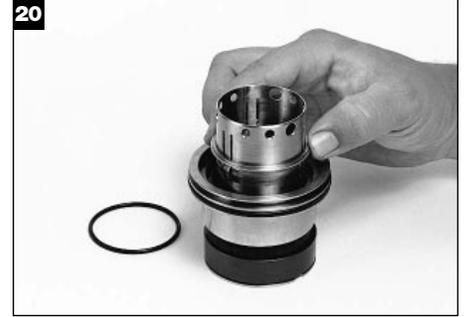
Faites glisser le joint plat de retenue sur la chemise, en appuyant, si nécessaire, sur les attaches d'entraînement tournantes, vers l'intérieur, jusqu'à ce qu'il butte sur le jeu d'attaches du milieu de la chemise. Faites glisser le diamètre intérieur du joint torique du collier contre le joint plat de retenue, en appuyant encore sur les attaches d'entraînement si nécessaire.
