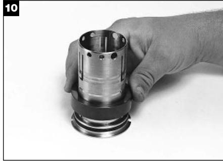
Placez le diamètre intérieur de la chemise et de diamètre extérieur des joints toriques dans leurs rainures. Faites glisser la partie tournante intérieure sur la chemise, en alignant les attaches d'entraînement avec les rainures de la partie tournante, jusqu'à ce qu'elle atteigne le fond.
