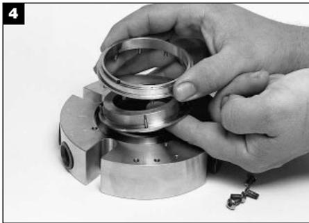
Faites pivoter le chapeau, puis retirez les vis à tête bombée CMC, le dispositif de retenue et le poussoir. Retirez les ressorts du poussoir.
