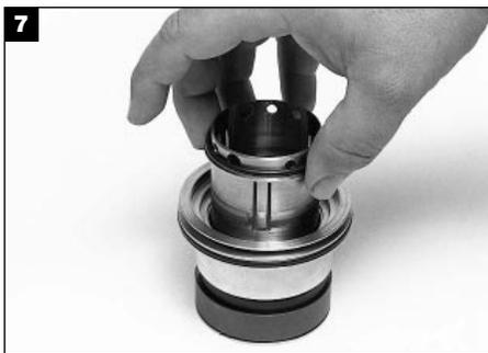
Retirez de la chemise le joint torique détaché, ainsi que le joint plat.
