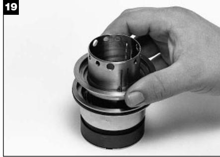
Faites glisser l'adaptateur sur la chemise jusqu'à ce qu'ils puissent guider dans le nez et que ses clavettes anti-rotations se fixent sur les rainures dans l'entraînement mécanique de la partie stationnaire.
