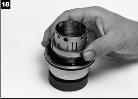
Faites glisser le dispositif d'entraînement de la partie stationnaire sur la chemise jusqu'à ce que ces ergots anti-rotations se fixent dans les rainures de la partie stationnaire.
