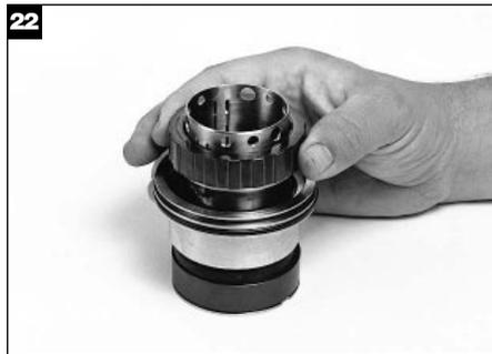
Faites glisser délicatement l'ensemble collier/partie tournante sur la chemise, en alignant les attaches d'entraînement avec les rainures de la partie tournante, jusqu'à ce qu'il s'accroche au joint plat de retenue et se fixe aux attaches d'entraînement extérieures de la partie tournante.
